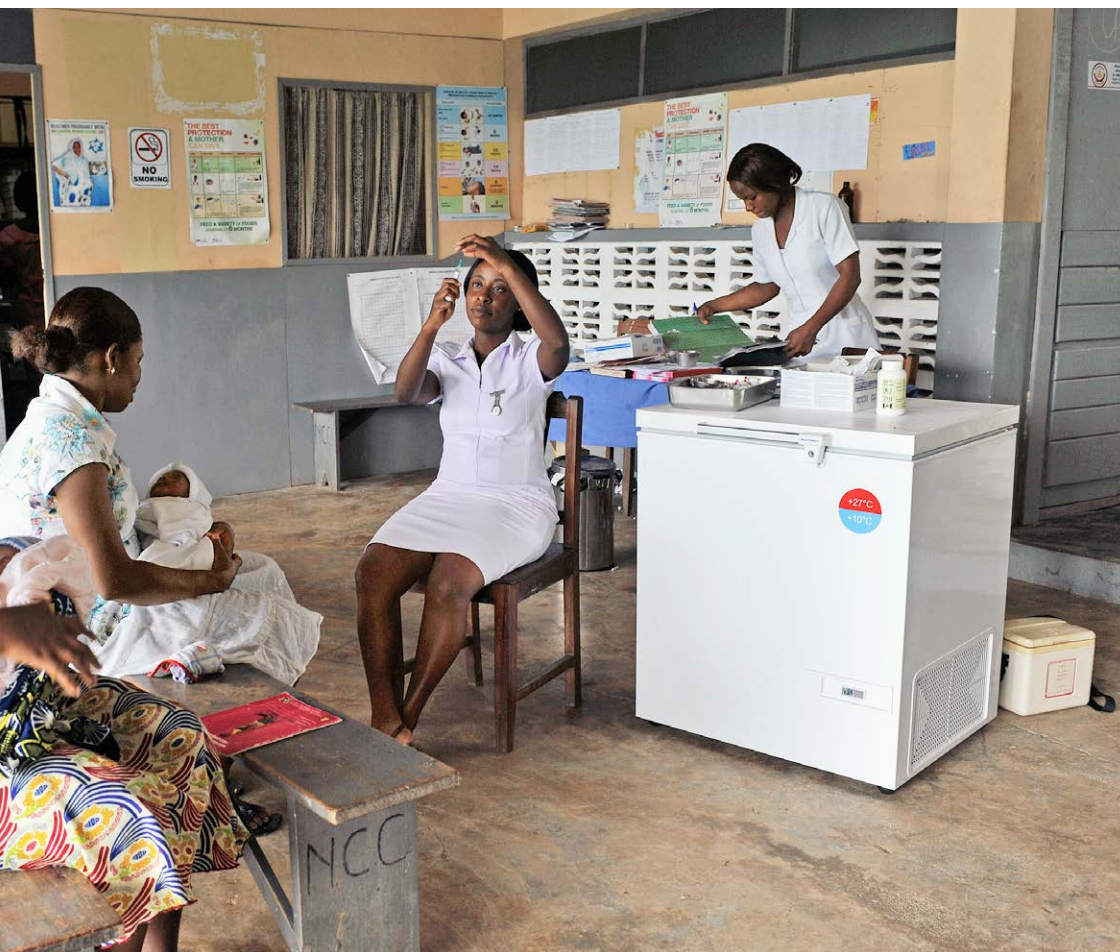
Der Kühlschrank Solar-Chill funktioniert dank Solarpanels mit 360 Watt Leistung. Damit können Medikamente und Impfstoffe auch in Gegenden ohne Stromversorgung gekühlt werden.
