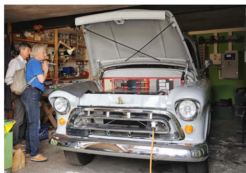
Findig: Ein alter Chevrolet dient als Energiespeicher.
