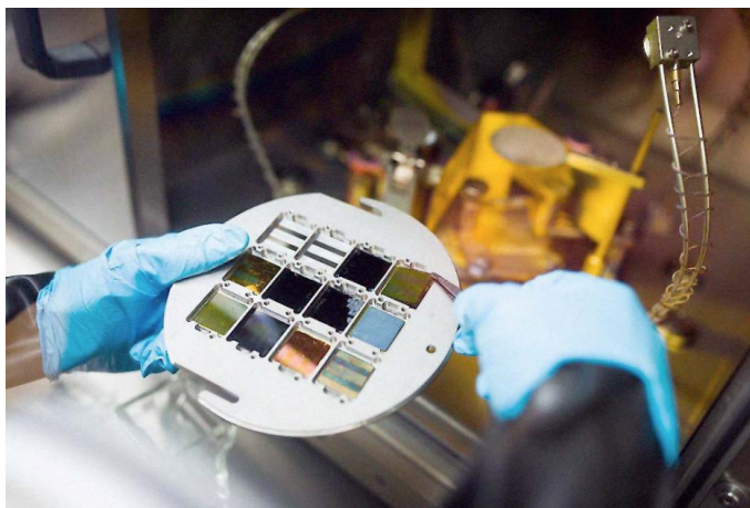
Perowskit-basierte Tandem-Solarzellen erreichen mittlerweile Ausbeuten an Solarstrom von mehr als 25 Prozent.
