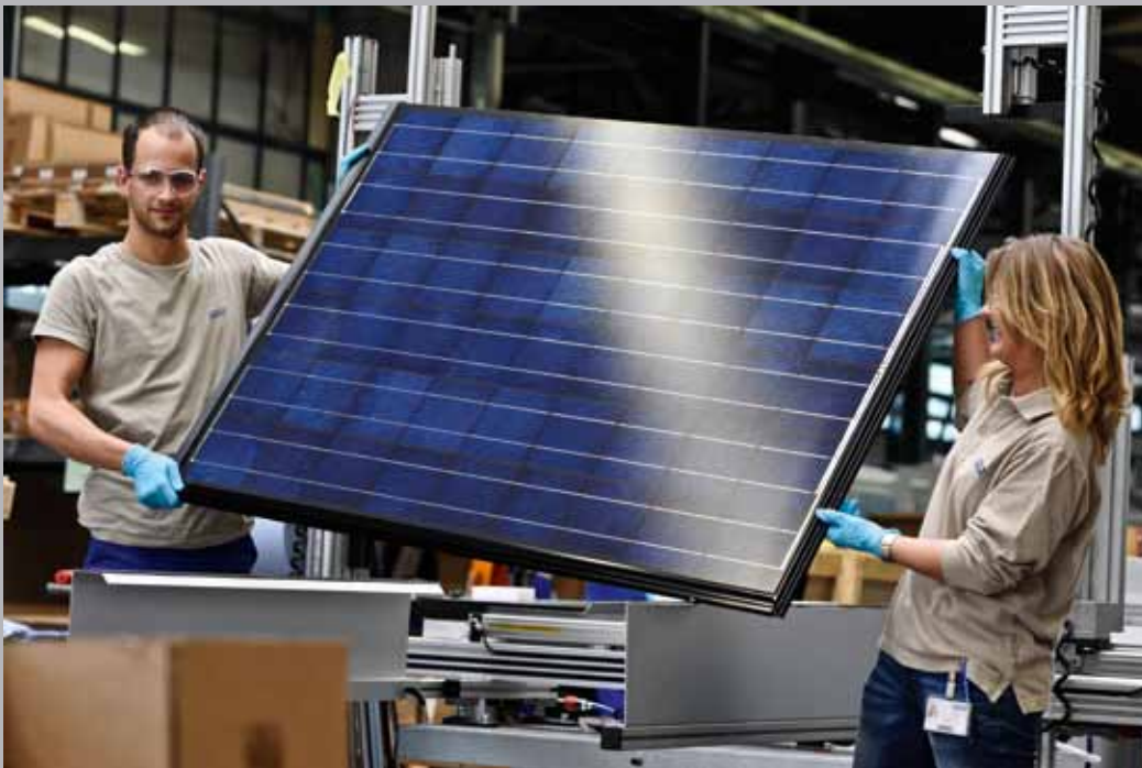
Tomo Kiklic und Gitta Pohl beim Rahmen von Photovoltaik-Modulen mit dem Montagesystem Solrif® von Schweizer.
